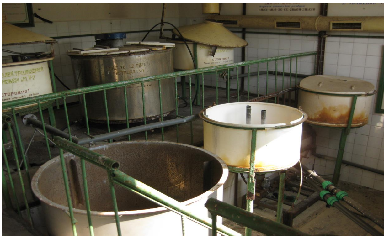
Рисунок 6. Электролизная установка
